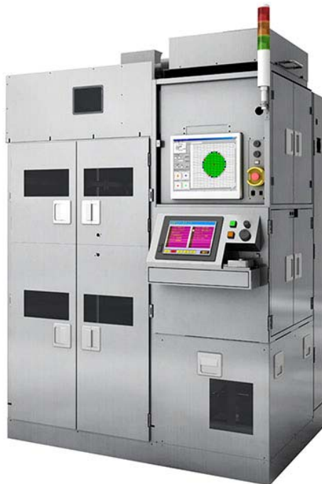
UX7-3Di LFS 200: 200 mm ウェーハ対応大面積ステッパ・リソグラフィ・システム
