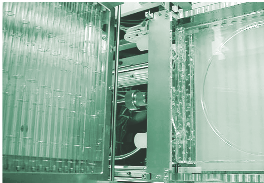
全長576mmの大型フラッシュランプが数多く搭載されているFLA装置の光源照射部
