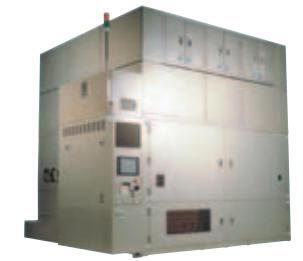
液晶パネル貼り合わせ用紫外線照射装置
