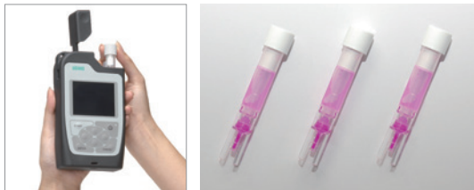
蛍光測定装置(左)と蛍光標識試薬イメージ(右)
