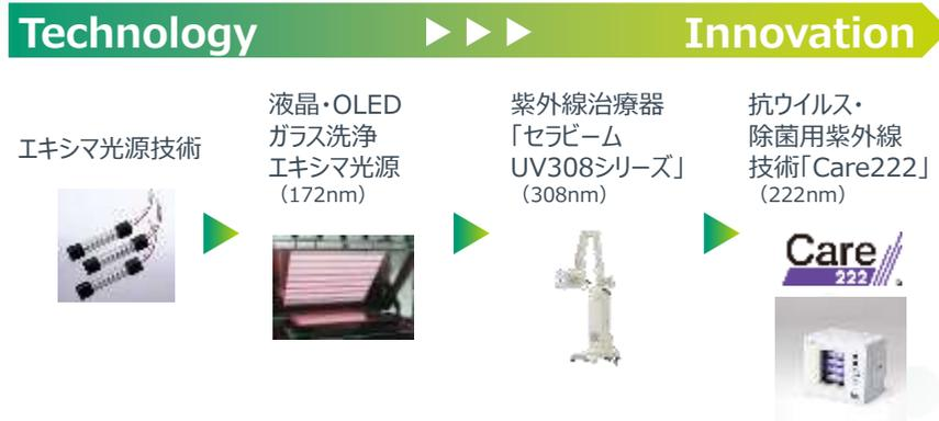
私達は、インダストリアルプロセス事業において、1990年頃より、高度な製造技術を求められる半導体や液晶パネル製造工程で、エキシマランプという特殊な光源を使い、クリーンな光による、非接触で不要な有機物を除去する工程に製品を提供しています。
