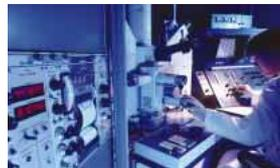
X線マイクロアナライザーによる材料分析
