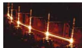
ハロゲンランプの封止工程
