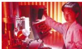
オージェ電子分光装置によるランプ材料の不良解析
