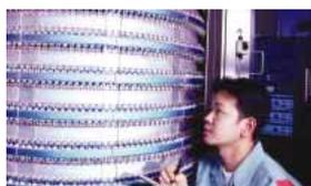
ハロゲンランプの封体蒸着加工
