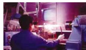
超高圧紫外線ランプの封止工程
