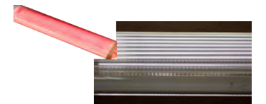
光によるN 2 OとCH 4 の低濃度一括分解リアクタのプロトタイプ
