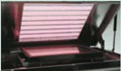
パネル洗浄用エキシマ光照射装置
