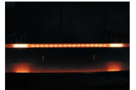
点灯時のマルチフィラメント・ヒータ®。中央部が低温部、両端が高温部。
