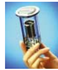
ソフトエレクトロンを放射する超小型電子ビーム管：Min-EB
