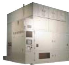
液晶パネル貼り合わせ用紫外線硬化装置
