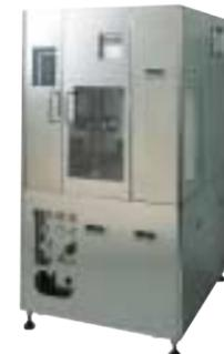
MEMS 用スプレーコーター (フォトレジスト塗布装置)
