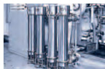
(1974) 紫外線水殺菌装置 低圧UVランプを内蔵した紫外線水殺菌装置
