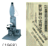
(1968) IC露光装置「ユニマスク」 プロジェクション方式を世界で初めて実用化 現在の「UXシリーズ」の原点
