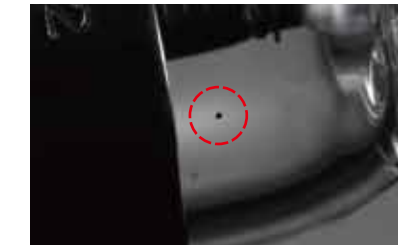
ガラスに異物が付着したもの ※ランプに使用している材料等が製造工程中に付着する場合がありますが、品質への影響はありません。
