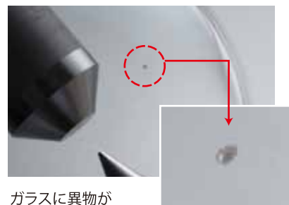
ガラスに異物が付着したもの ※ランプに使用している材料等が製造工程中に付着する場合がありますが、品質への影響はありません。
