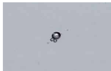
ガラス中の気泡 ※気泡はガラス内部に閉じ込められたもので、品質への影響はありません。
