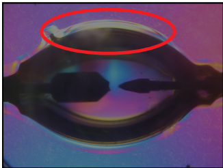
図1 鋭敏色法で観察された歪の写真。応力部分の屈折率が変わるため色が異なって見えます。
